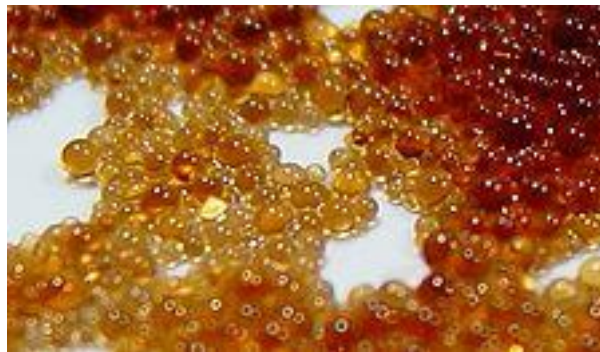
ioncserélő gyanta szemcsék (nagyított) átlagos szemcseméret \text{Ø} \approx 1 \text{ mm}
