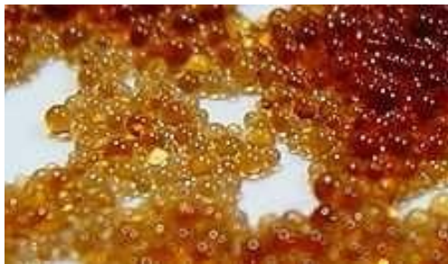
nagyított ioncserélő gyanta szemcsék átlagos szemcseméret \text{Ø} \approx 1 \text{ mm}
